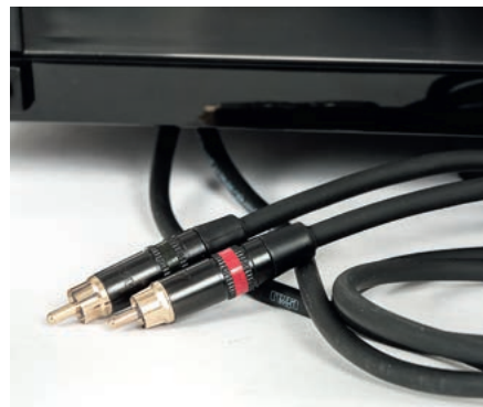
Nie ma możliwości łatwej wymiany przewodów sygnałowych, także i w nowym Planarze 6 , Rega nie przewidziała dodatkowej żyły uziemiającej.
